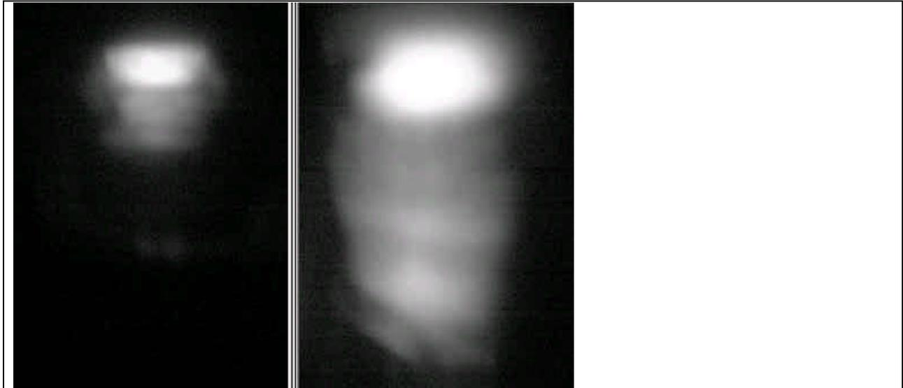
Abb. 7: links Bumm Lumotec mit HS3 bei 6,5 V und rechts LED-Eigenbau bei 500 mA
