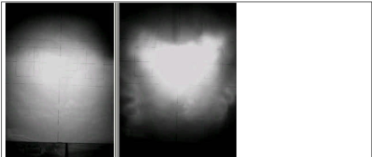
Abb. 8: links HalberFL mit 5W Lambert-Strahler bei 550 mA, rechts Aufa 12V mit HS4
