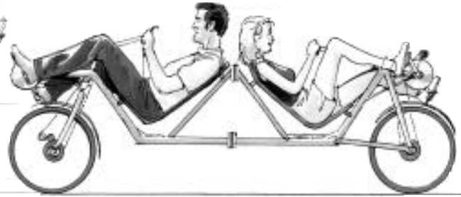
Symmetrisch deelbare stalen rug-aan-rug tandem (kameel) EK Keulen 1997
